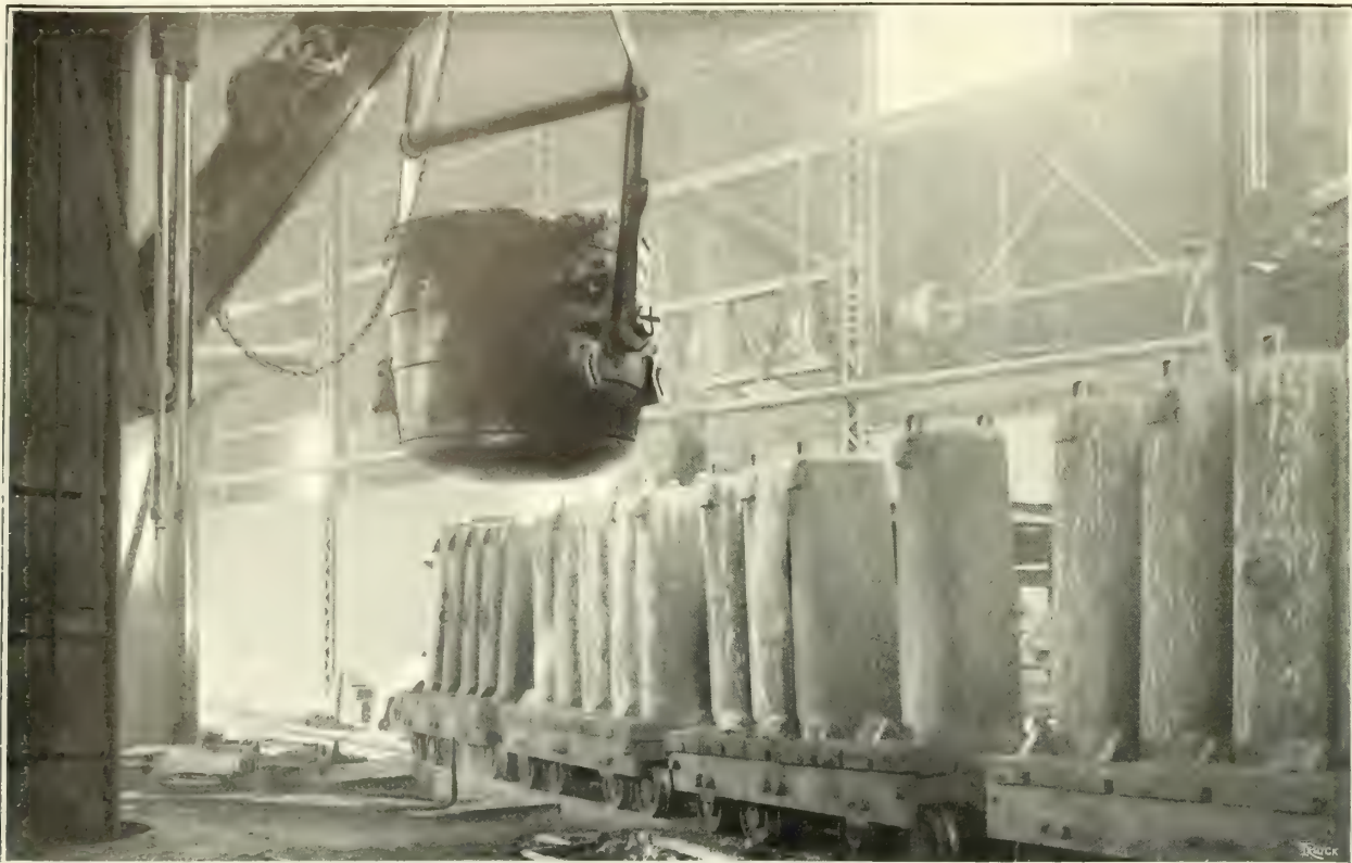
LA COULÉE DE L'ACIER. — A peine sorti du haut fourneau, l'acier en fusion tombe dans une poche énorme de métal, appelée « tasse », qui le déverse dans les « lingotières » disposées à cet effet sur des wagons.
